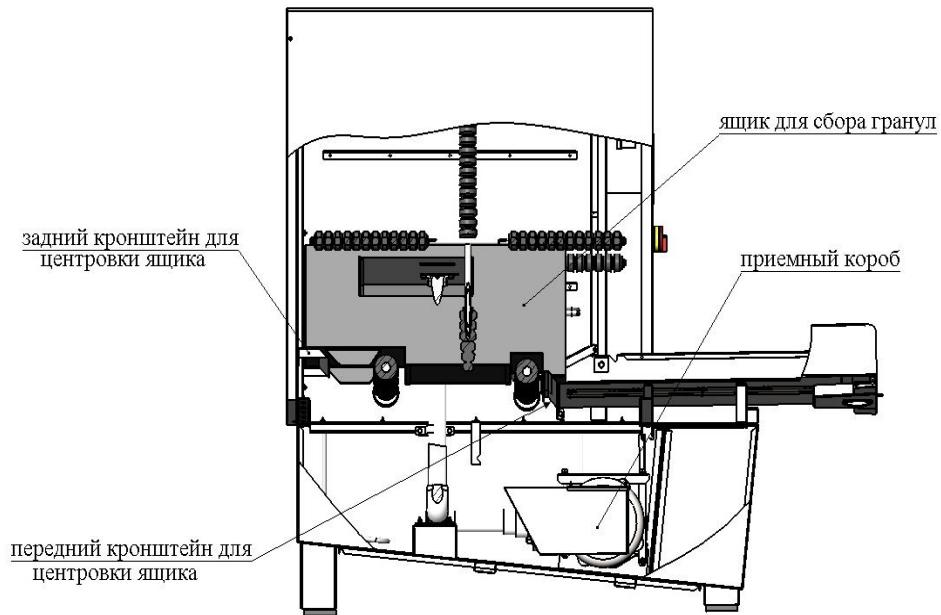
Рис.7. Установка ящика для сбора гранул.
