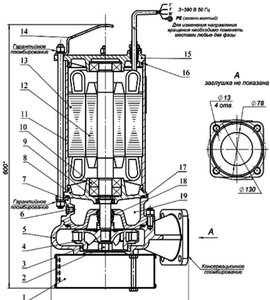
**Рис.10 Устройство электронасоса**
